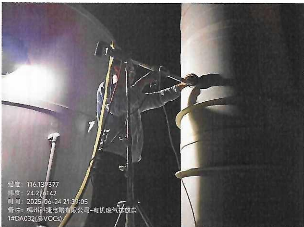
有机废气排放口 1#DA032：总 VOCs
