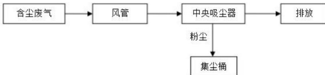
图 2.6-1 粉尘处理工艺流程图
