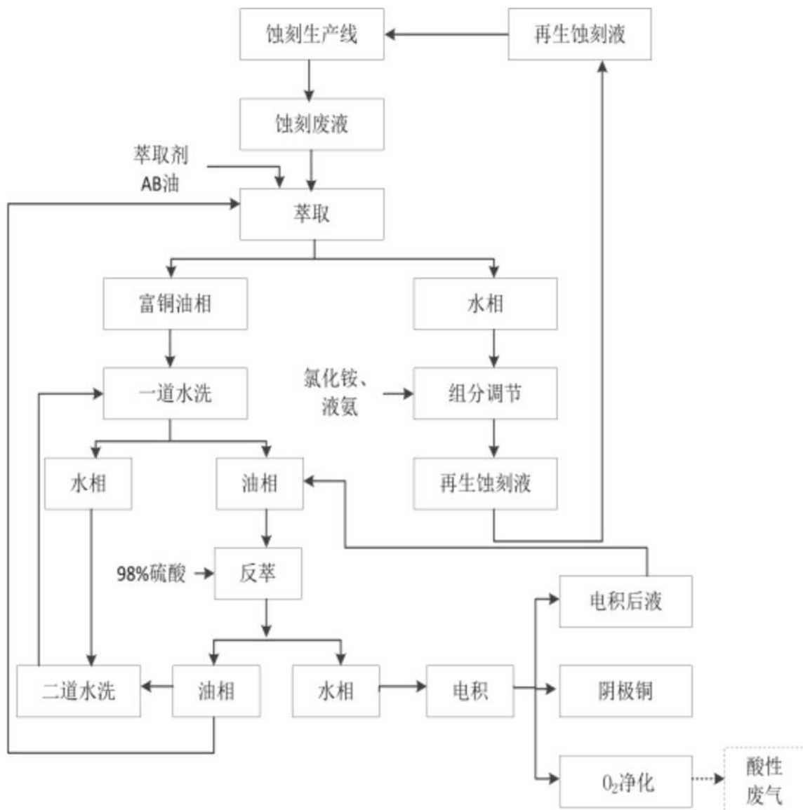
图 3.4-5 碱性蚀刻液回收系统工艺流程图
