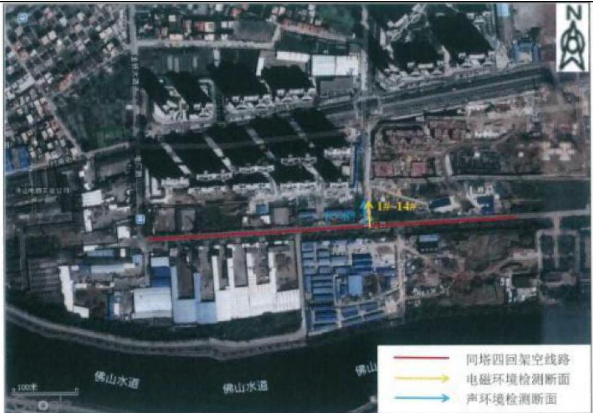
图 4.10-2 类比对象（同塔四回架空线路）布点示意图
