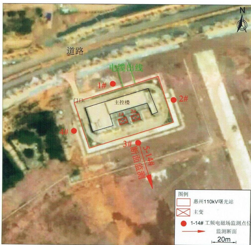
图 8.1-6 惠州 110 千伏曙光变电站监测布点图
