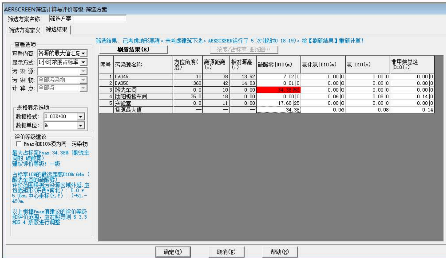
图 1.9-2 主要大气污染物应用估算模式结果截图 (最大落地浓度占标率)
