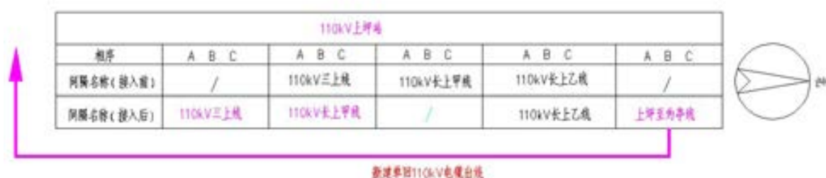
图2-4 110kV上坪站110kV间隔布置示意图
