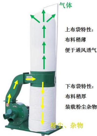
图 4-1 移动式布袋除尘器工作吸尘原理示意图
